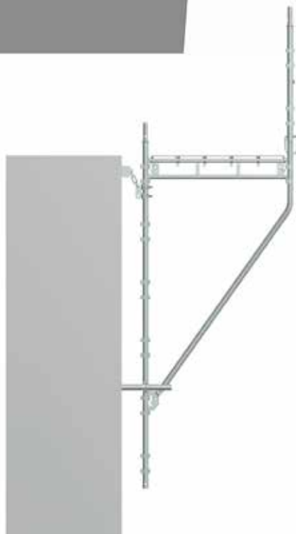
Eksempel på hengende stillas med konsoll.
